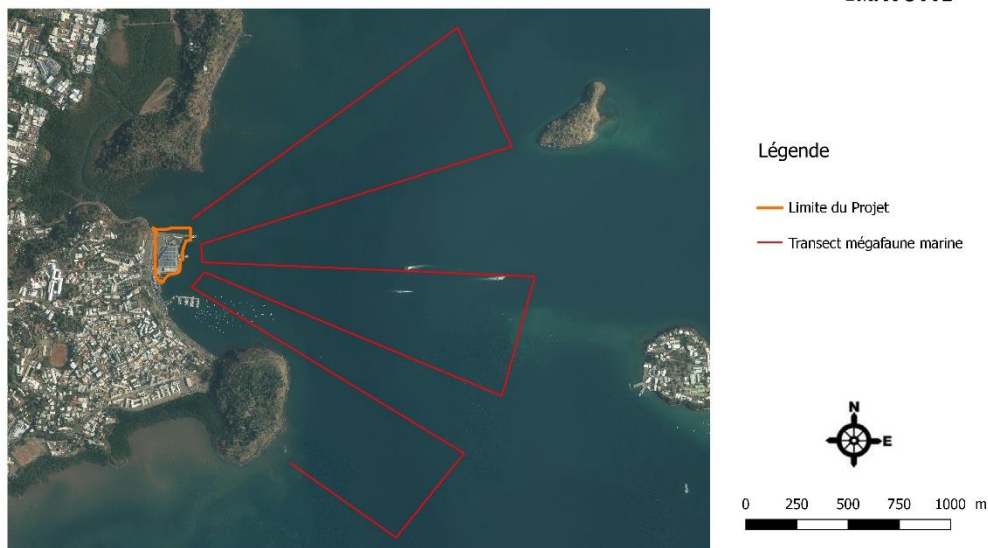
Figure 64 : Transect pour le suivi de la mégafaune marine. La limite la plus éloignée du projet a été définie à 1 mile nautique afin de permettre de couvrir toute la zone et de compiler ce suivi avec les autres suivis.
